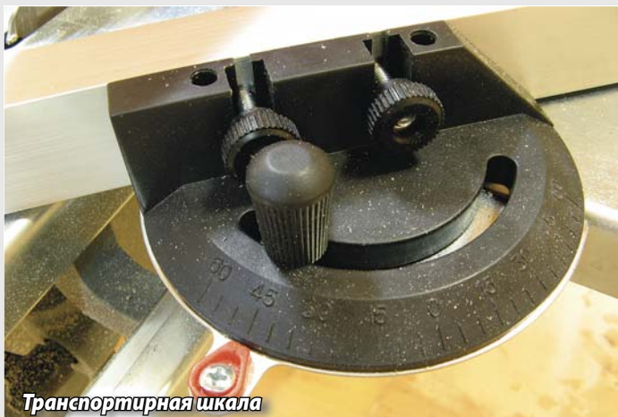
Регулировка упора крайнего положения (перпендикулярный рез)
