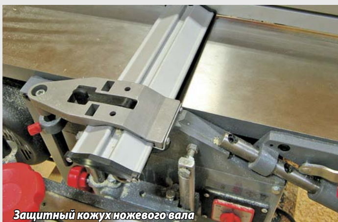
Регулировка высоты установки ножей
