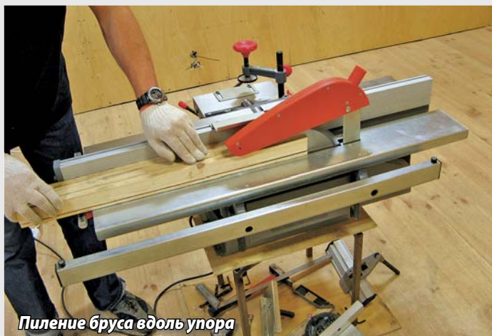
Пиление бруса вдоль упора с наклоном
