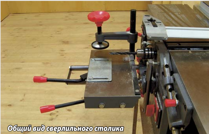
Регулировка высоты сверлильного столика
