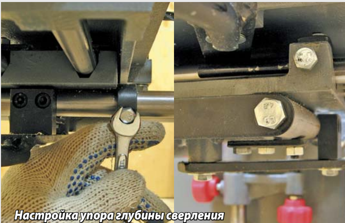
Упорную пластину можно переустановить и регулировать
